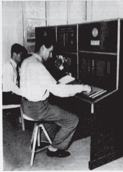
Abb. 2. Der Schalter bei der Festlegung eines Rechnerplatzes. Die Ableser für den Lochstreifen sind deutlich sichtbar.
