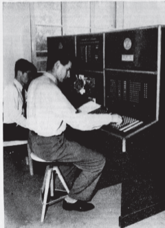
Abb. 2. Der Schaltapparat bei der Fertigung eines Rechenplanes. Die Abtaster für den Lochstreifen sind deutlich sichtbar.
