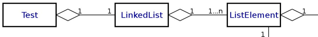
Abbildung 2: Einfaches Klassendiagramm (ohne Methoden) zum Programmaufbau. Der "Pfeil" mit dem Rhombus bezeichnet eine Aggregation (has-a-Relation). Die Pfeile lassen sich an den Feldern in den Klassen ablesen und umgekehrt. Der Rhombus symbolisiert die "Variable" (Feld), deswegen liegt es auf der Seite der benutzenden Klasse.
