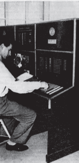
Abb. 1. Der Schaktpal bei der Fertigung eines Rechengärtens. Die Abtaster für den Lochstreifen sind deutlich sichtbar.
