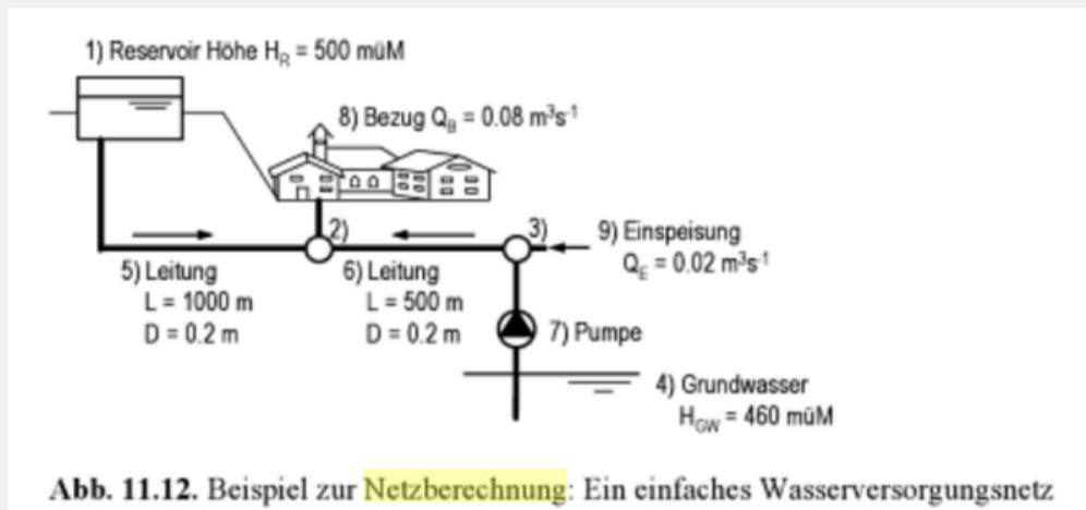
Abb. 11.12. Beispiel zur **Netzberechnung**: Ein einfaches Wasserversorgungsnetz
